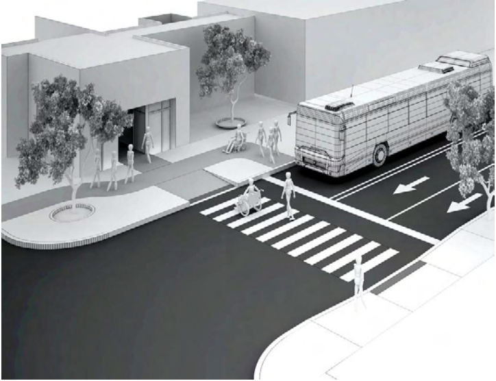
Perspectiva: Representación de una ruta accesible en espacio público y al exterior.
